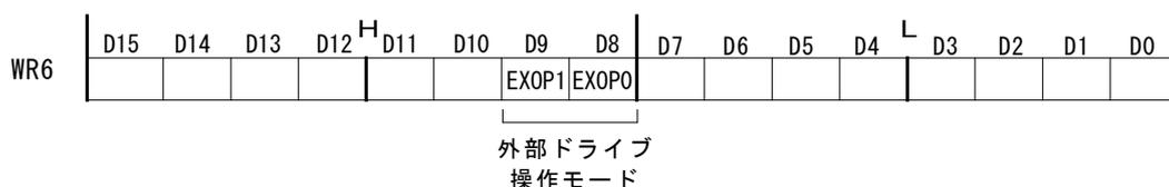
外部入力信号 (nEXPP, nEXPM) によるドライブ操作モードはD9,8ビットの2ビットで設定を行います。各ビットの値に対応するドライブ操作モードは下表のようになります。
